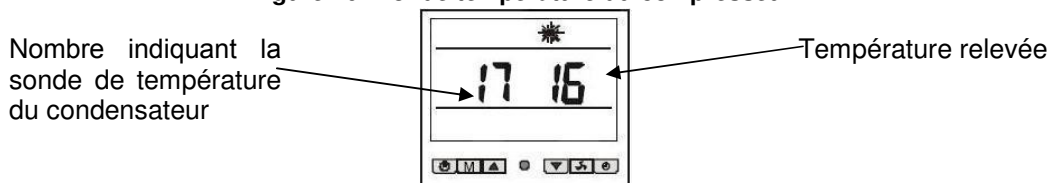
Figure 21: Sonde température du condensateur.
